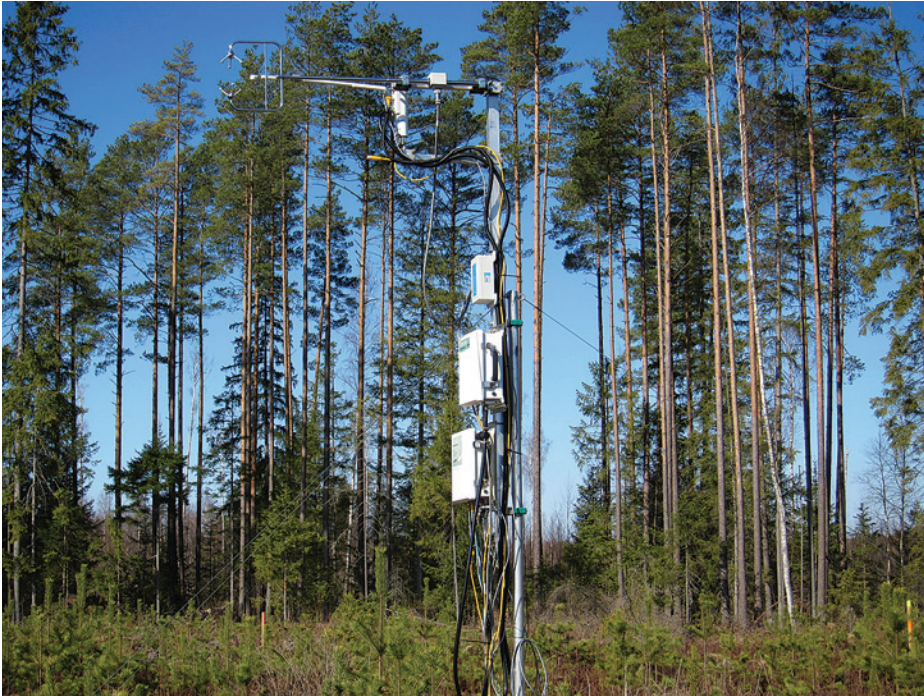
Joonis 5. Anemomeetri ja analüsaatoriga jaam männinoorendikus võimaldab mõõta gaasivahetust ökosüsteemi ja atmosfääri vahel.
