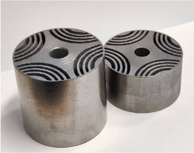
Joonis 6. 3D-prinditud sünkroon- reluktantsmasina rootorid.
