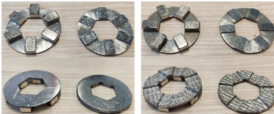
Joonis 9. 3D-prinditud optimeerimata (vasakul) ja optimeeritud (paremal) magnetiline sidur.
