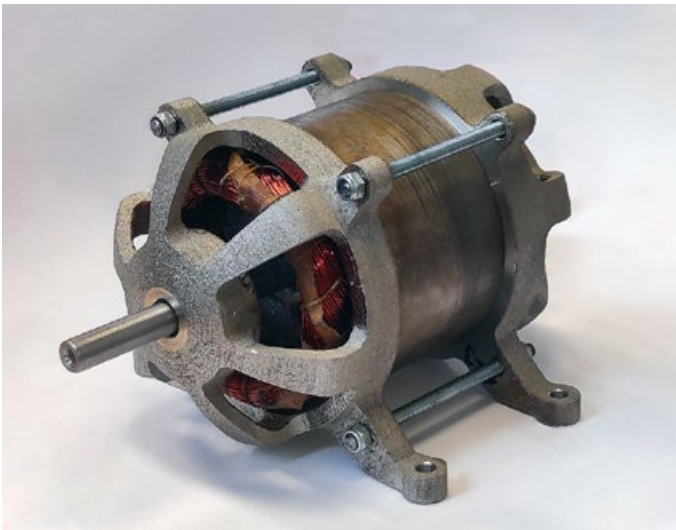
Joonis 7. 3D-prinditud asünkroonmootor, mille mähised on valmistatud traditsioonilisel meetodil.
