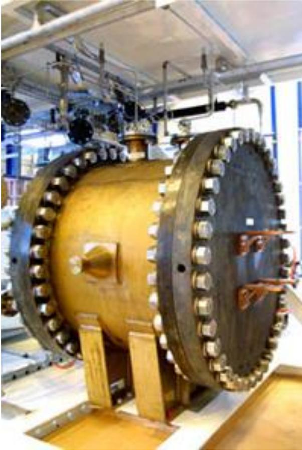
GHW on välja töötatud 500 kW<sub>el</sub>, 30 bar rõhul leeliselise PME (pressure module electrolyzer) elektrolüüseri
