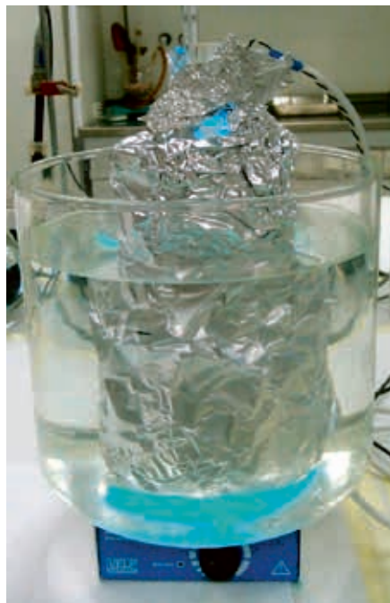
Foto 1. Sünteetilise magusaine atsesulfaami lagun- damine UV-kiirgusega aktiveeritud persulfaadiga. Foto: Eneliis Kattel
